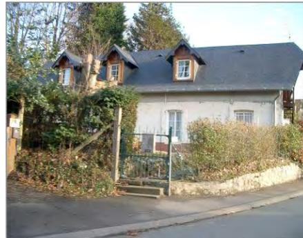
Les toits en chaume ont disparu sur la commune. La tuile l'a remplacé. Elle peut être mécanique donnant alors aux toitures une couleur rouge ou orangé. La tuile plate a été utilisée sur quelques bâtiments, elle est encore utilisée et parfois vieillie artificiellement.
