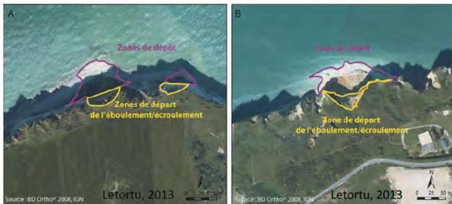
Le recensement des éboulements/écroulements réalisés à partir des images aériennes prises par l'IGN entre 1939 et 2008 a permis d'identifier 599 mouvements de masse entre le Cap d'Antifer et Le Tréport.
